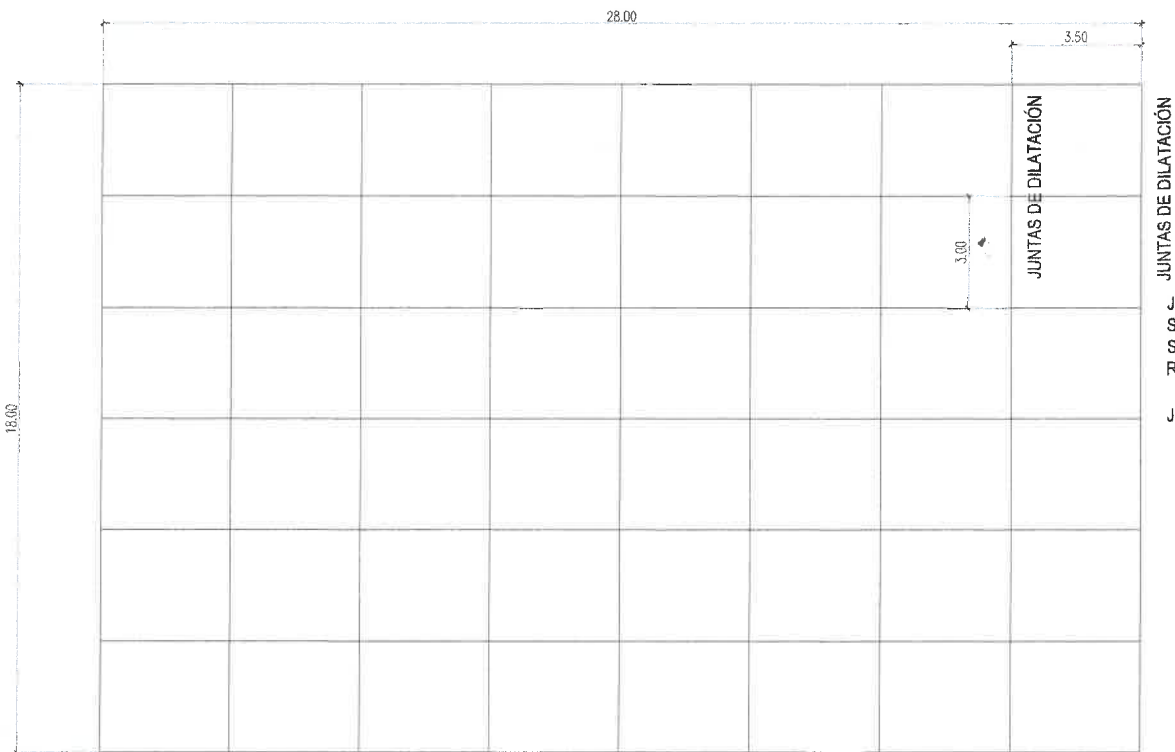
JUNTAS DE DILATACIÓN - ESC. 1:100
