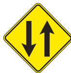
Inicio de Doble Circulación
