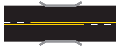
Líneas Continuas y Discontinuas Paralelas (Línea discontinua del lado del carril que se circula: traspaso autorizado)
