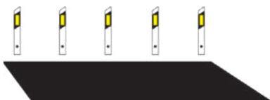
Delineadores (Canalizan o guían el tránsito y destacan variaciones en la vía)
