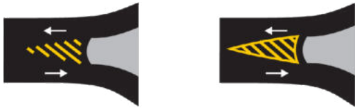
Marcas Canalizadoras de Tránsito e Isletas para Circulación Bidireccional (No se puede circular sobre ellas)
