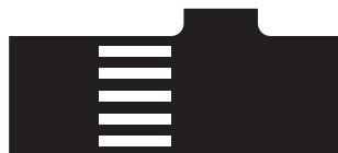
Senda Peatonal (Prohibido detener o estacionar vehículos sobre la misma)
