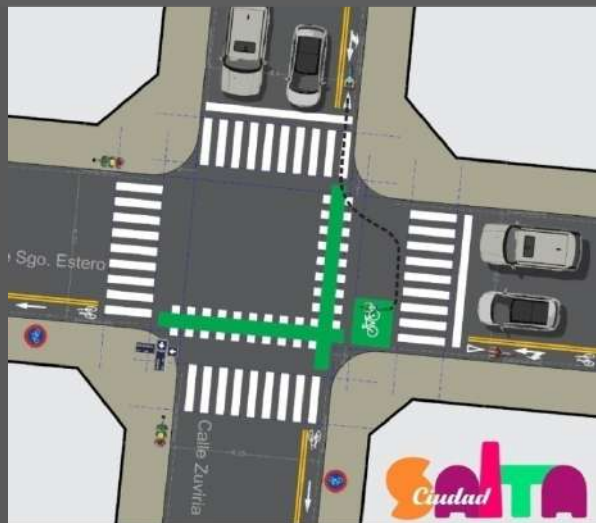
Detalle interseccion ciclovía, cruces y sendas peatonal
